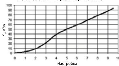
Рис. 104. Диаграмма для настройки клапана MSV-F2  $D_y = 65 \text{ мм}$
