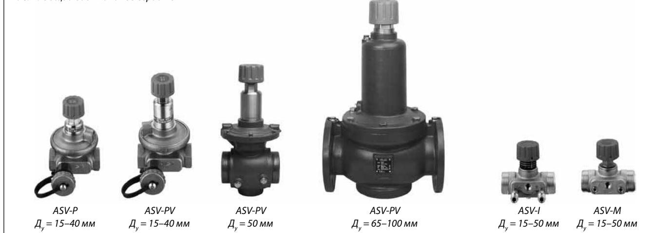
Автоматические балансировочные клапаны серии ASV — регуляторы постоянства перепада давлений, предназначенные для гидравлической балансировки трубопроводных систем тепло- и холодоснабжения при переменных расходах проходящей через них среды в диапазоне от 0 до 100%.
