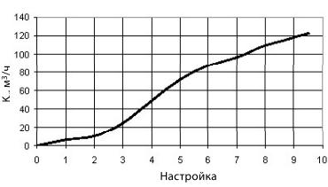
Рис. 105. Диаграмма для настройки клапана MSV-F2  $D_y = 80 \text{ мм}$
