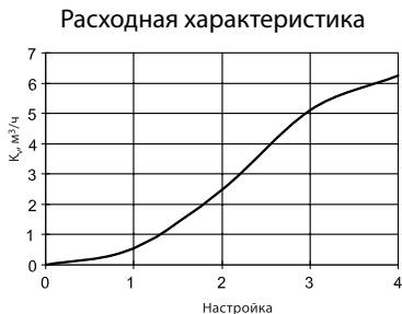
Рис. 99. Диаграмма для настройки клапана MSV-F2  $D_y = 20\text{ мм}$
