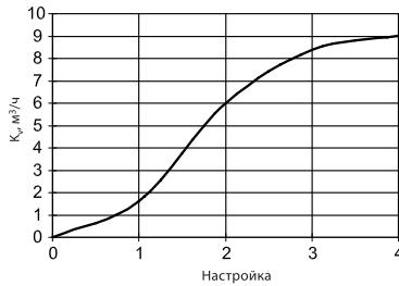
Рис. 100. Диаграмма для настройки клапана MSV-F2  $D_y = 25$  мм
