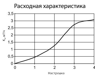
Рис. 98. Диаграмма для настройки клапана MSV-F2  $D_y = 15\text{ мм}$
