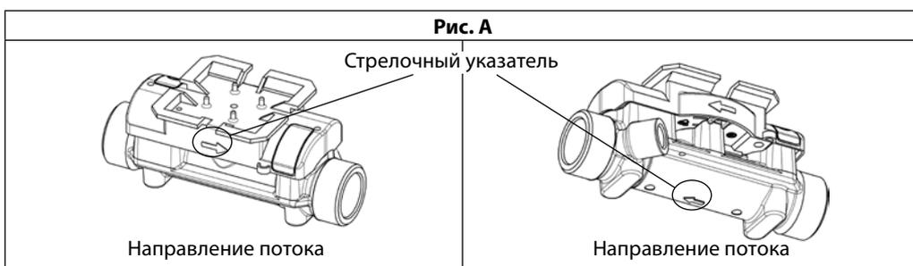
По окончании установки расходомер должен быть постоянно заполнен жидкостью. Установки элементов для гидродинамической стабилизации потока до и после расходомера не требуется. Теплосчетчик можно устанавли-
