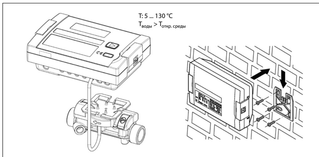
Чтобы упростить демонтаж прибора учета, рекомендуется устанавливать запорную арматуру до и после расходомерной части. Прибор
