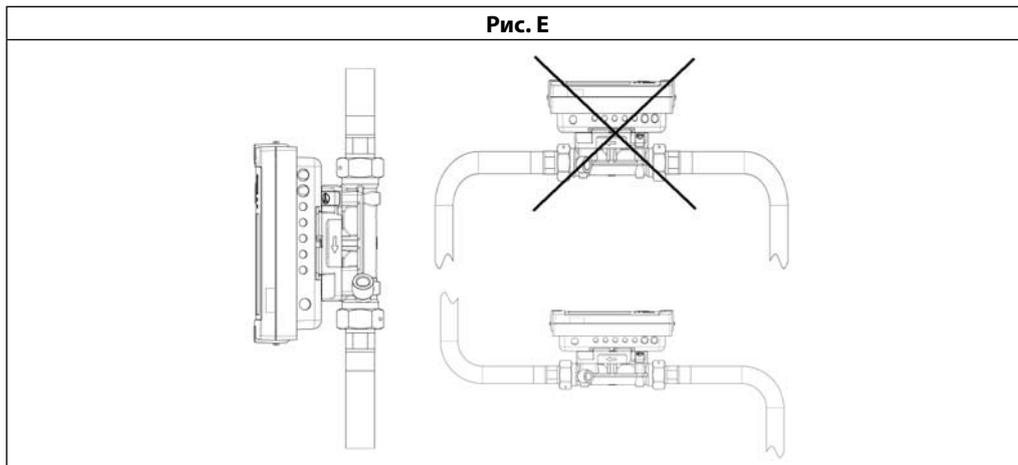
Прибор учета должен быть установлен на достаточном расстоянии от возможных источников электромагнитных помех (выключатели, электродвигатели, флуоресцентные лампы и т. п.).
