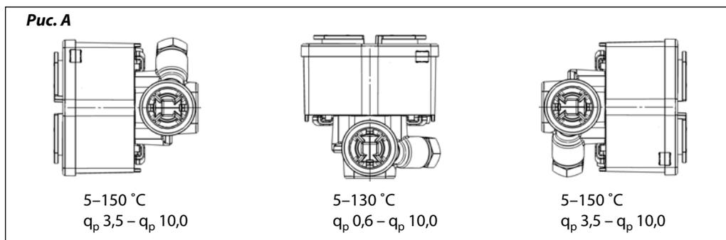
2. Направление потока теплоносителя должно соответствовать направлению стрелки на
