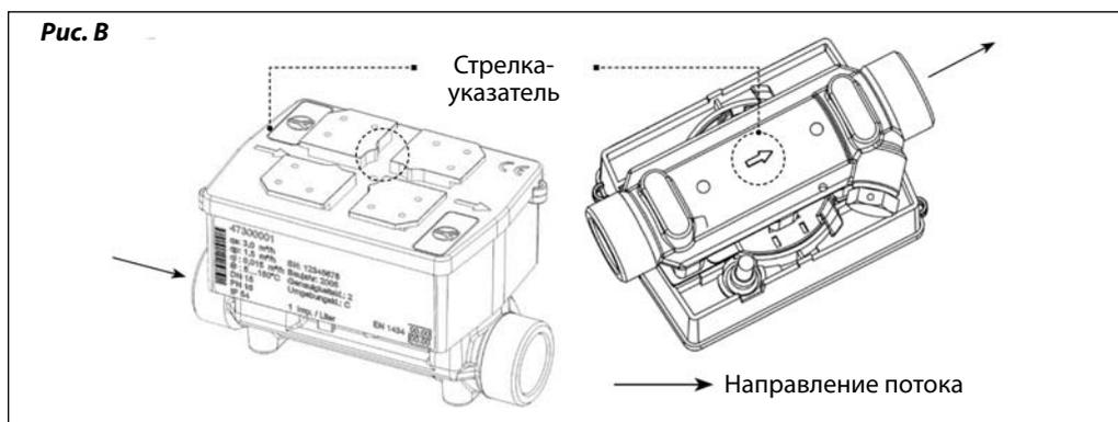
3. Установка осуществляется таким образом, чтобы расходомер был всегда полностью заполнен водой после ввода в эксплуатацию.
