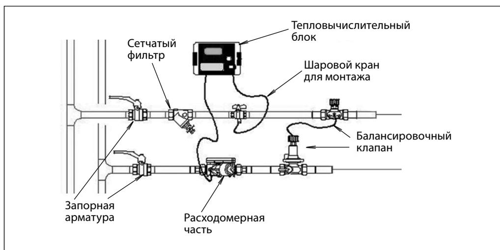
Не допускается монтаж теплосчетчика на подающем трубопроводе, если он предназначен
