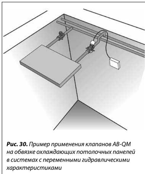
**Рис. 30.** Пример применения клапанов АВ-QM на обвязке охлаждающих потолочных панелей в системах с переменными гидравлическими характеристиками
