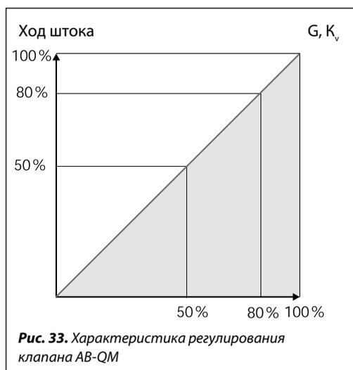
Так как клапан имеет практически линейную характеристику регулирования, то если уменьшить значение  $K_v$  регулирующего клапана в 2 раза, расход теплоносителя также уменьшится в 2 раза. То есть, для того чтобы в 2 раза уменьшить расход, необходимо наполовину закрыть клапан.
